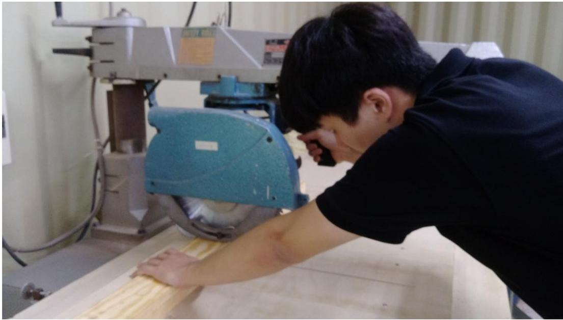
圖 3-10 使用懸臂鋸機備製材料長度 (拍攝者：呂俊良)
