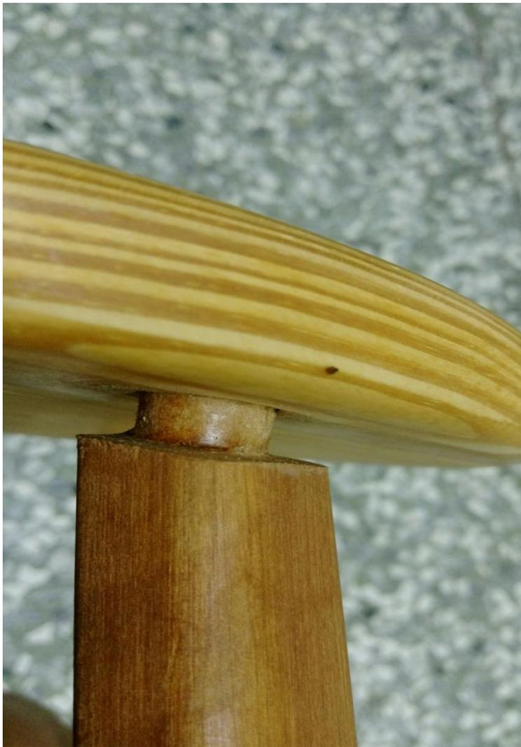
圖 1-1 榫頭脫離榫孔的現象 (拍攝者：呂俊良)
