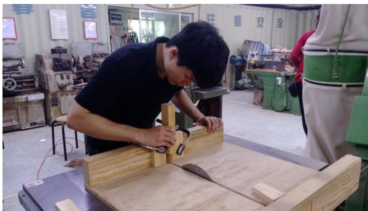
圖 3-22 以圓鋸機鋸切 0 度木楔鋸縫 (拍攝者：呂俊良)
