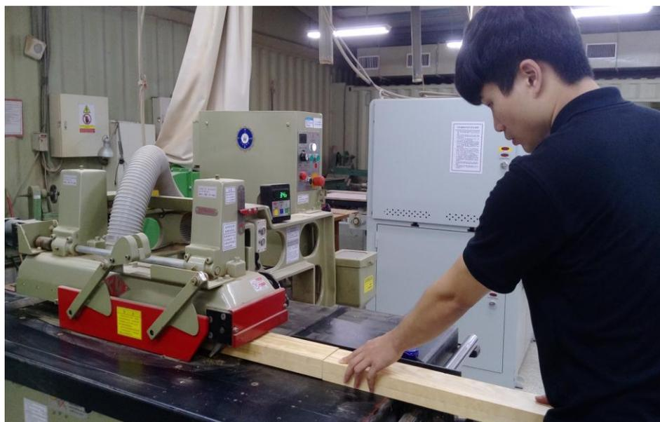
圖 3-13 使用自動縱開鋸機備製材料寬度 (拍攝者：呂俊良)
