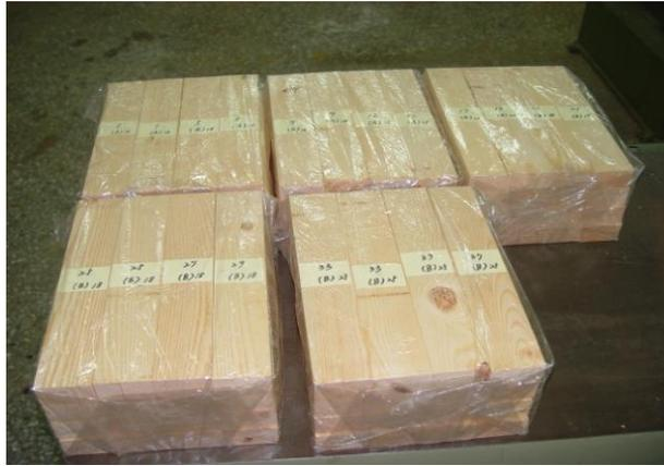
圖 3-21 以塑膠袋套封避免試件回潮 (拍攝者：鄭順福)
