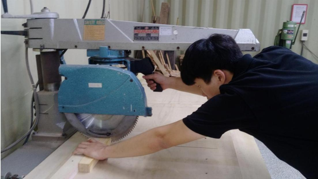
圖 3-14 使用懸臂鋸機定長度（拍攝者：呂俊良）
