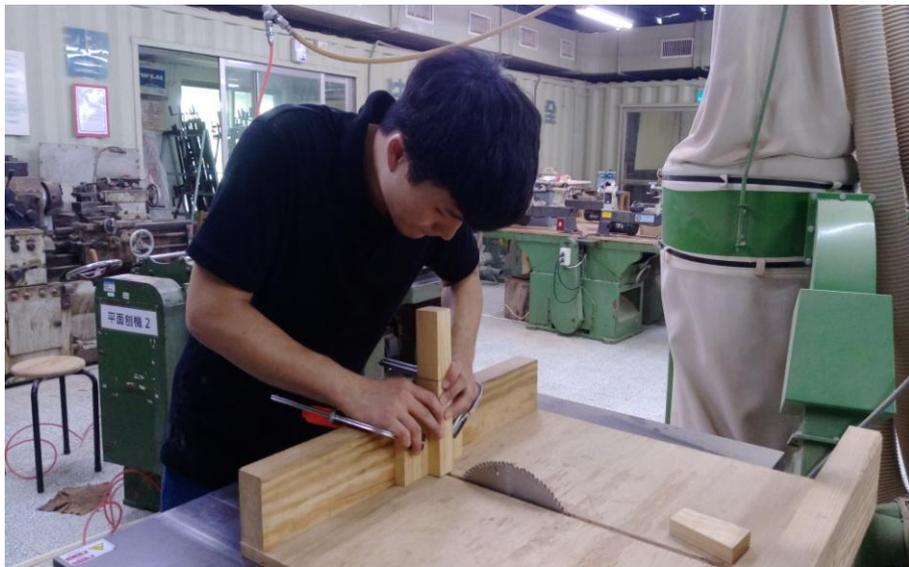
圖 3-17 使用橢圓孔機製作榫孔試件 (拍攝者：呂俊良)
