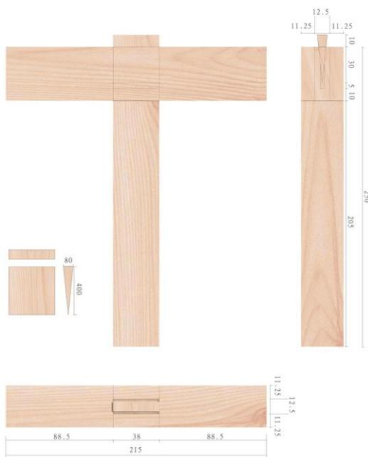
圖 3-7 試件 A 設計圖（繪圖者：呂俊良）
