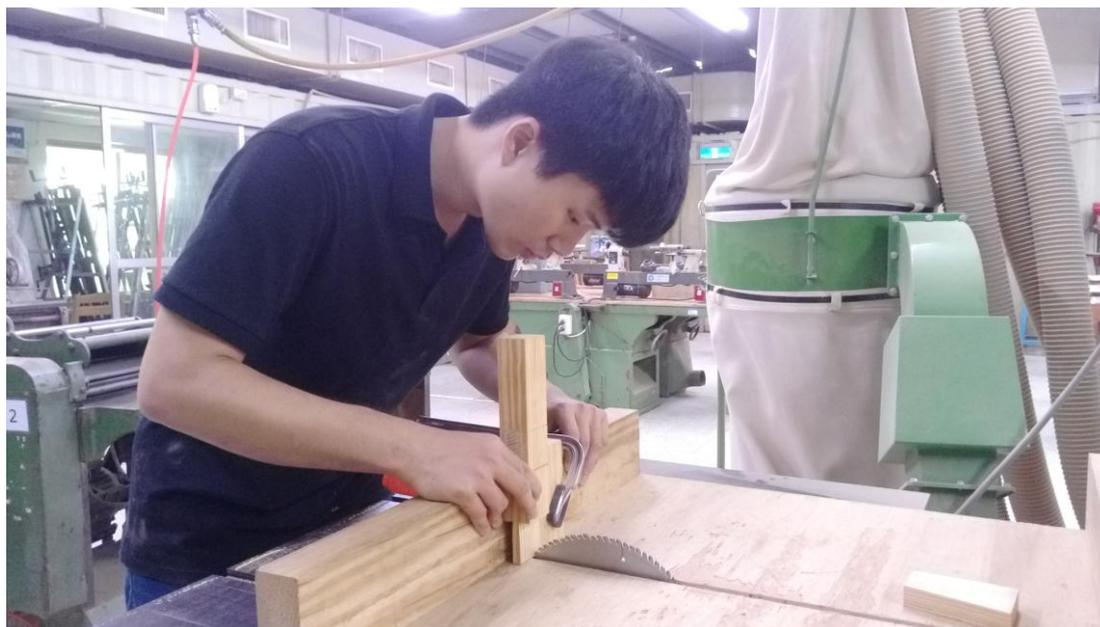
圖 3-23 以圓鋸機鋸切 90 度木楔鋸縫 (拍攝者：呂俊良)
