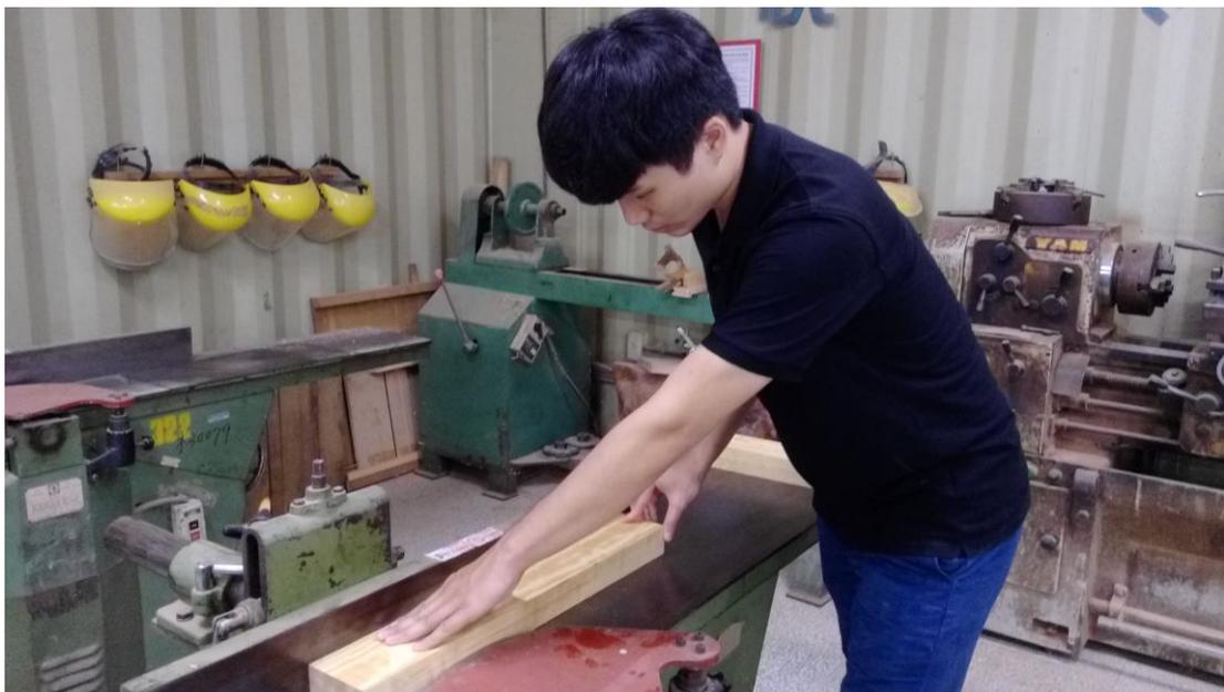
圖 3-11 使用手壓鉋木機鉋削基準面及直角邊 (拍攝者：呂俊良)
