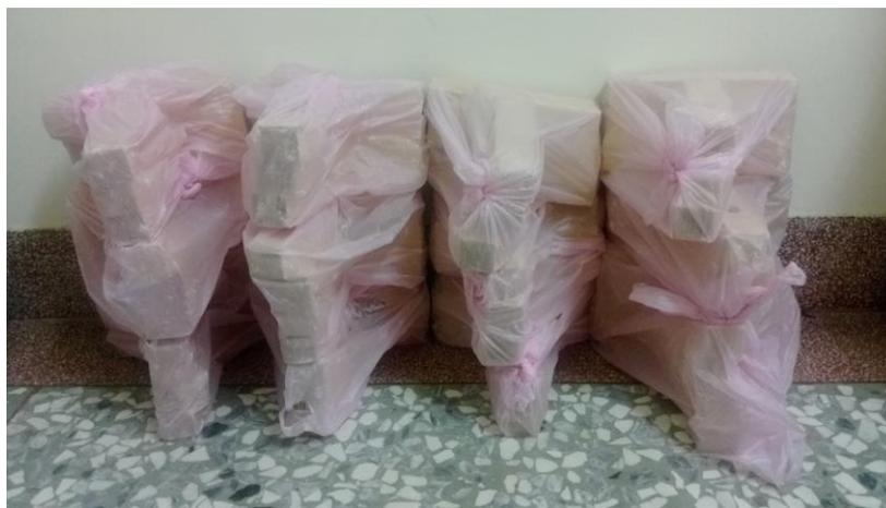
圖 3-29 試件組合後以塑膠袋套封（拍攝者：呂俊良）
