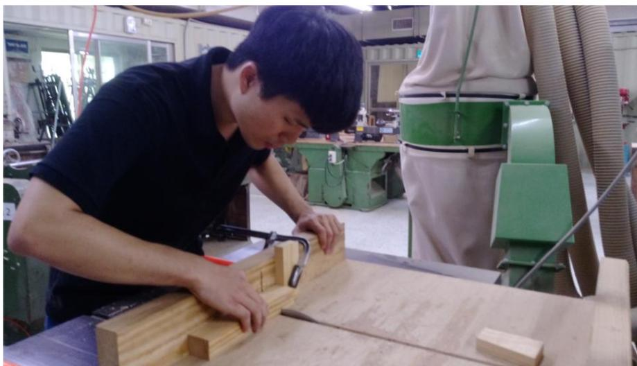
圖 3-19 使用圓鋸機製作方形貫穿榫頭試件 (拍攝者：呂俊良)
