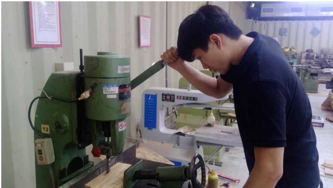
圖 3-16 使用橢圓孔機製作榫孔試件（拍攝者：呂俊良）
