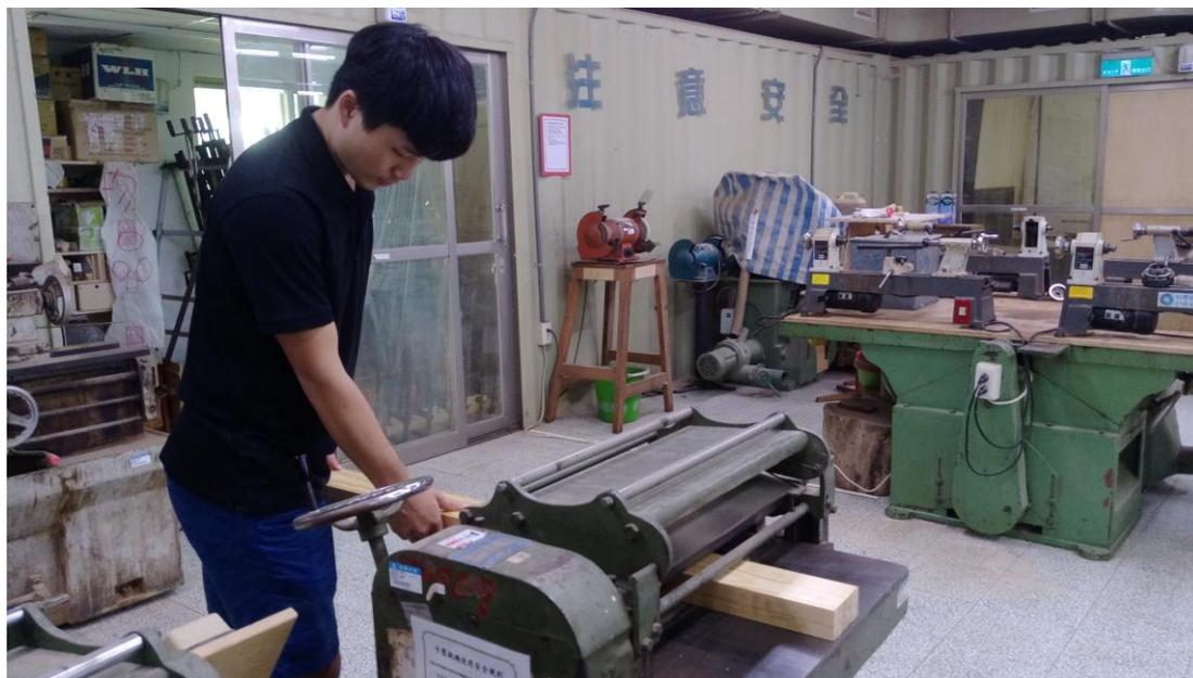
圖 3-12 使用自動鉋木機鉋削材料寬厚度 (拍攝者：呂俊良)
