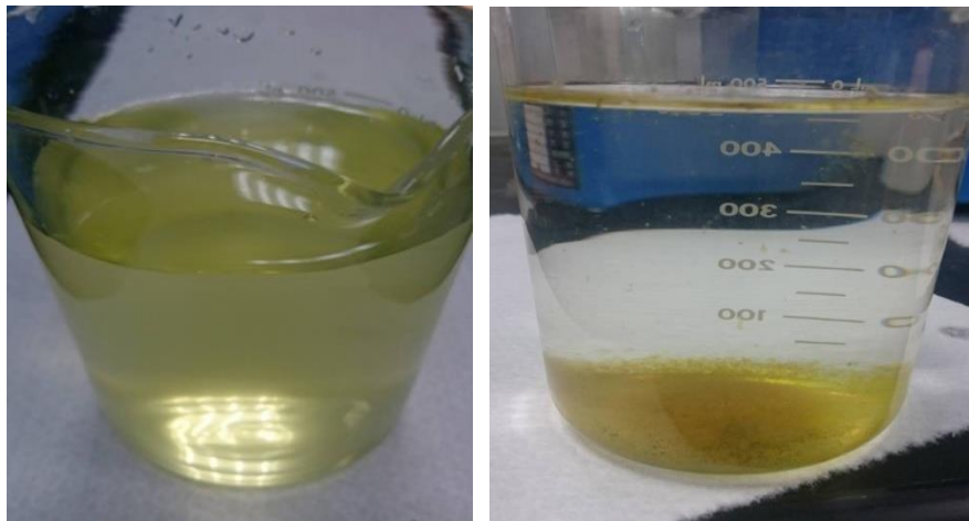
圖 8 含藻原水混沉前後圖(左側混沉前，右側混沉後)
