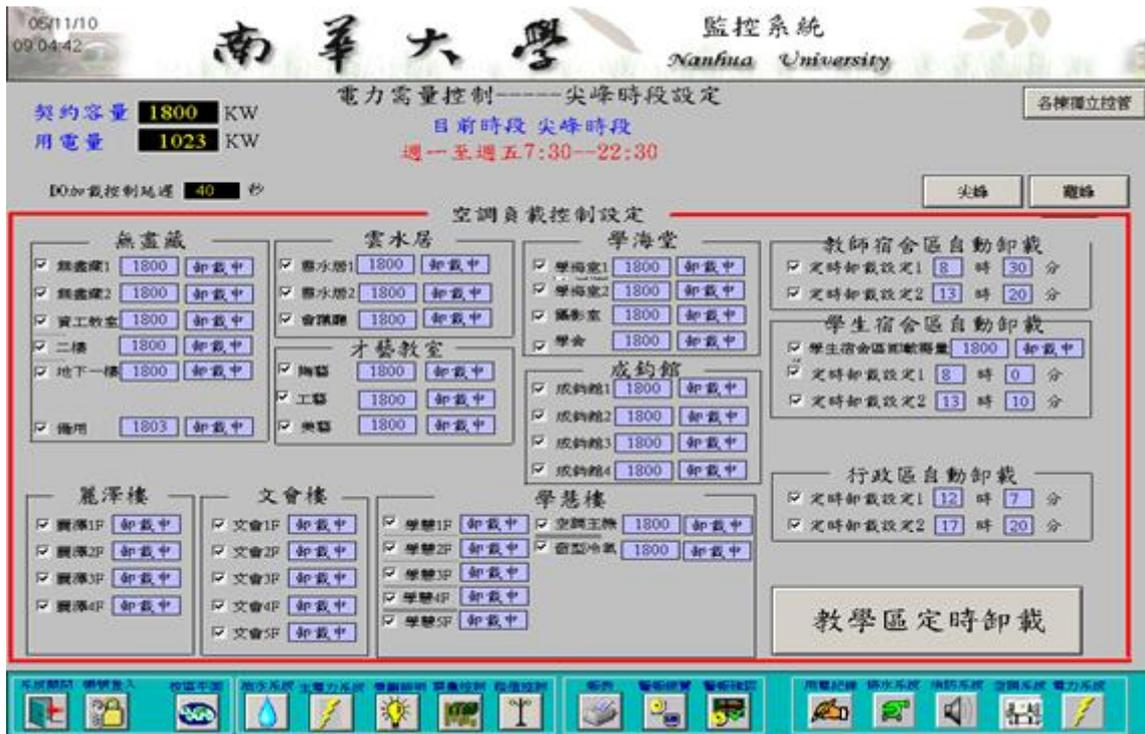
圖 16 控制系統依契約狀況暫停主機運轉
