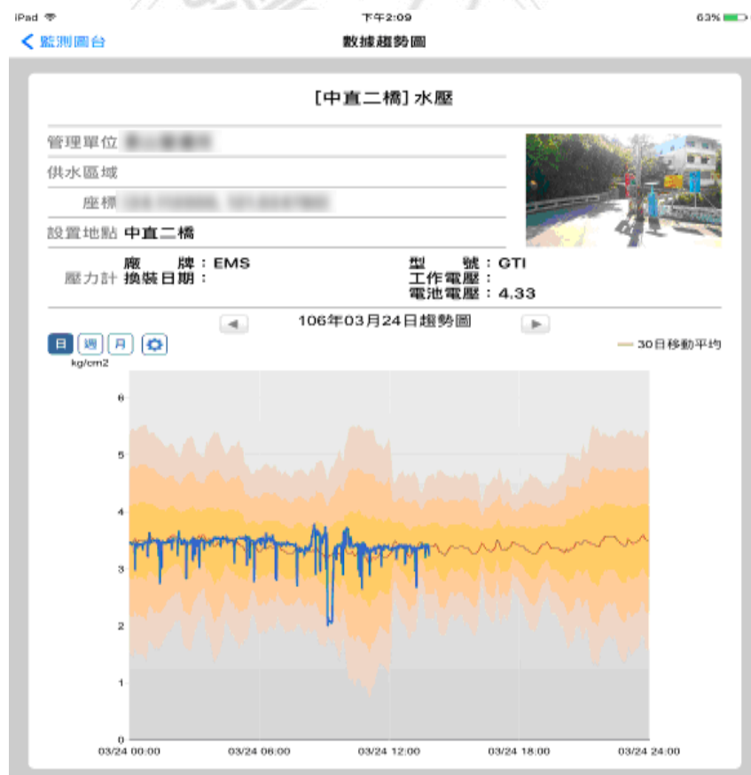
圖 4.16 供水監測資訊平台導入標準差管理的行動裝置畫面
