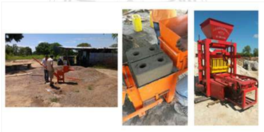
圖 4-8-7 製磚機-手動與自動製磚機進場 資料來源：本研究拍攝
