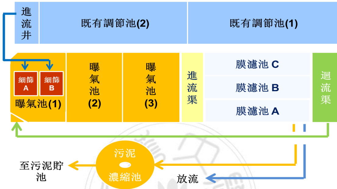
圖 1 新竹工業區東區污水廠處理流程圖
