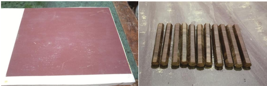
圖 4.16 貼 150 粒砂紙板(左)、已拆橡皮帶的木條(右)
