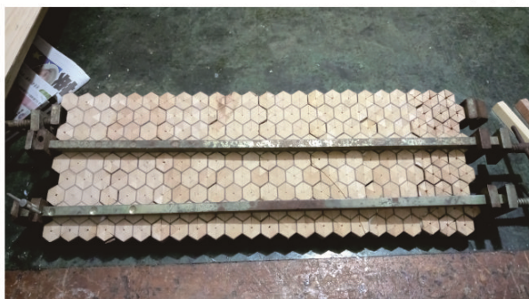
圖 4.19 木板模擬拼接圖(上)、木板拼接使用夾具(下)
