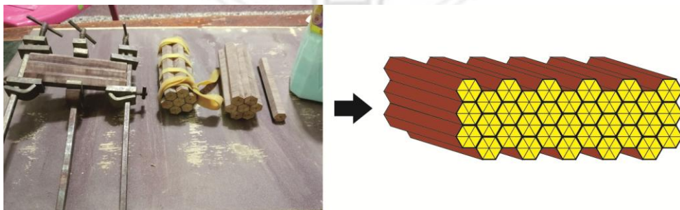
圖 4.17 夾具夾緊和橡皮綁緊(左)、組合模擬圖
