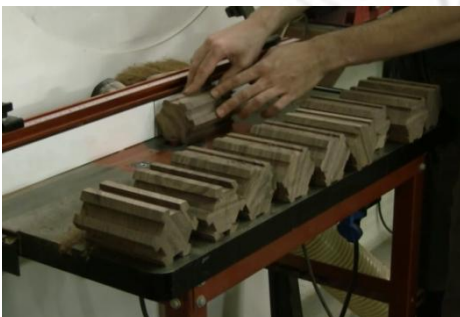
圖 2.7 打榫孔的過程
