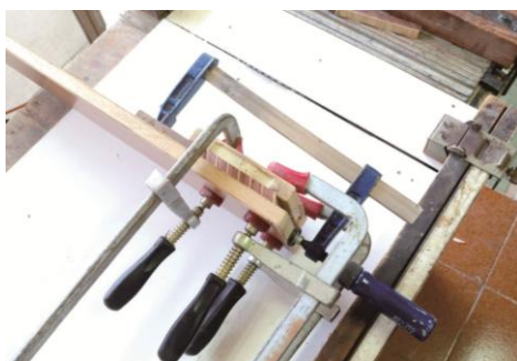
圖 4.24 平行四邊形膠合使用夾具過程
