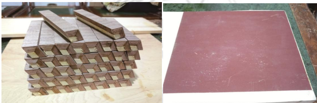
圖 4.33 將此木條兩面(左)用砂紙板(右)磨平
