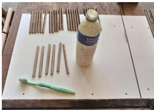
圖 4.14 橫鋸切的單元材料膠合組合、組合六邊形的流程
