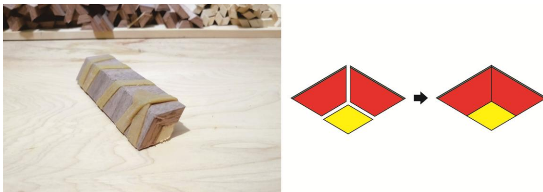
圖 4.32 膠合好已綁緊的木條(左)、波浪狀組合流程(右)
