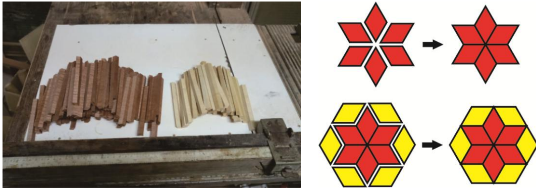
圖 4.4 橫鋸切的多個木條、十二個平行四邊形拼接過程
