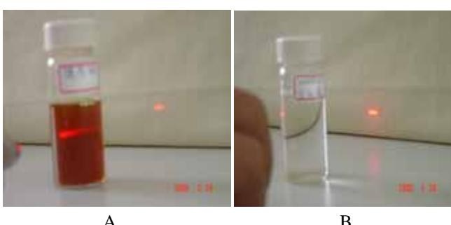
圖七 溶液(含 SDS、甲醛) A 圖：未加入  $\text{AgNO}_3$  前無散射現象。B 圖：加入  $\text{AgNO}_3$  後溶液呈黃褐色並有散射現象
