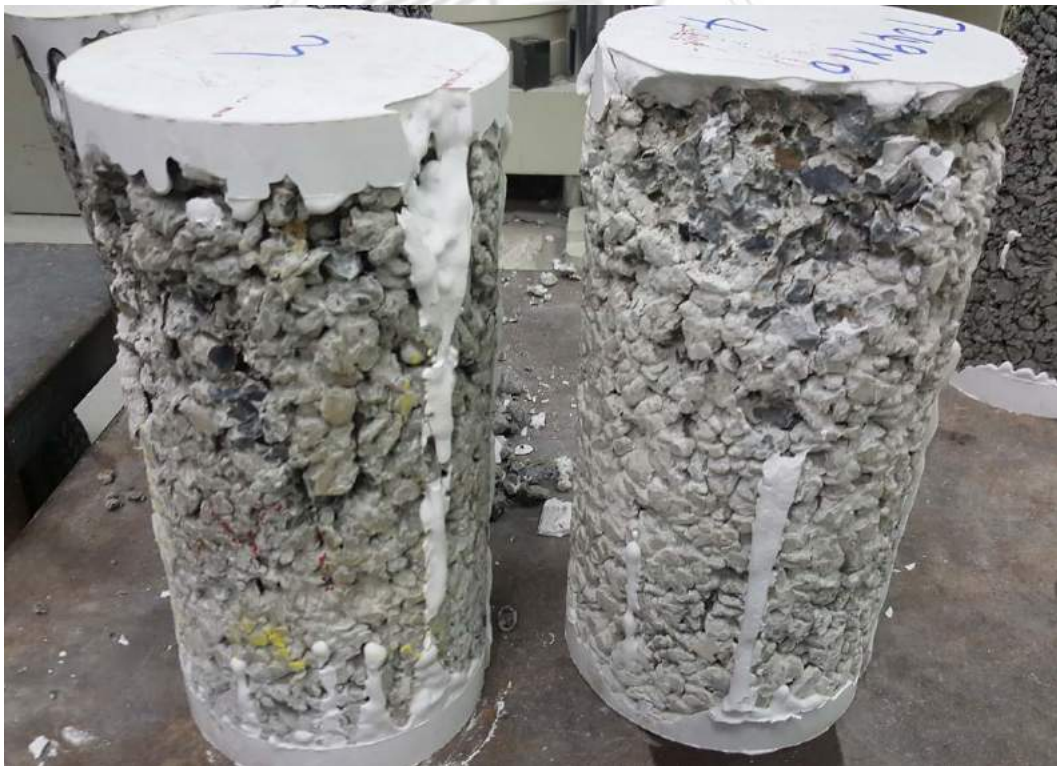
圖 3.6 實驗中混凝土抗壓性試驗配比(2-1、2-2 組)
