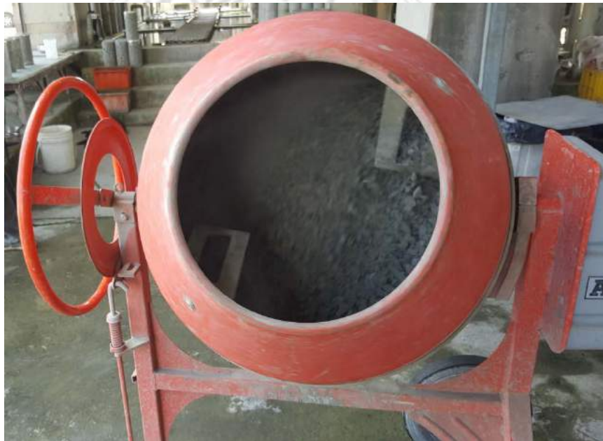
(e) 使用混凝土攪拌機將試體材料進行拌和
