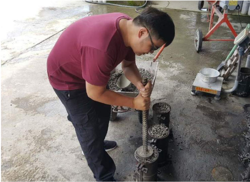
(h) 將試體材料進行最後夯實作業
