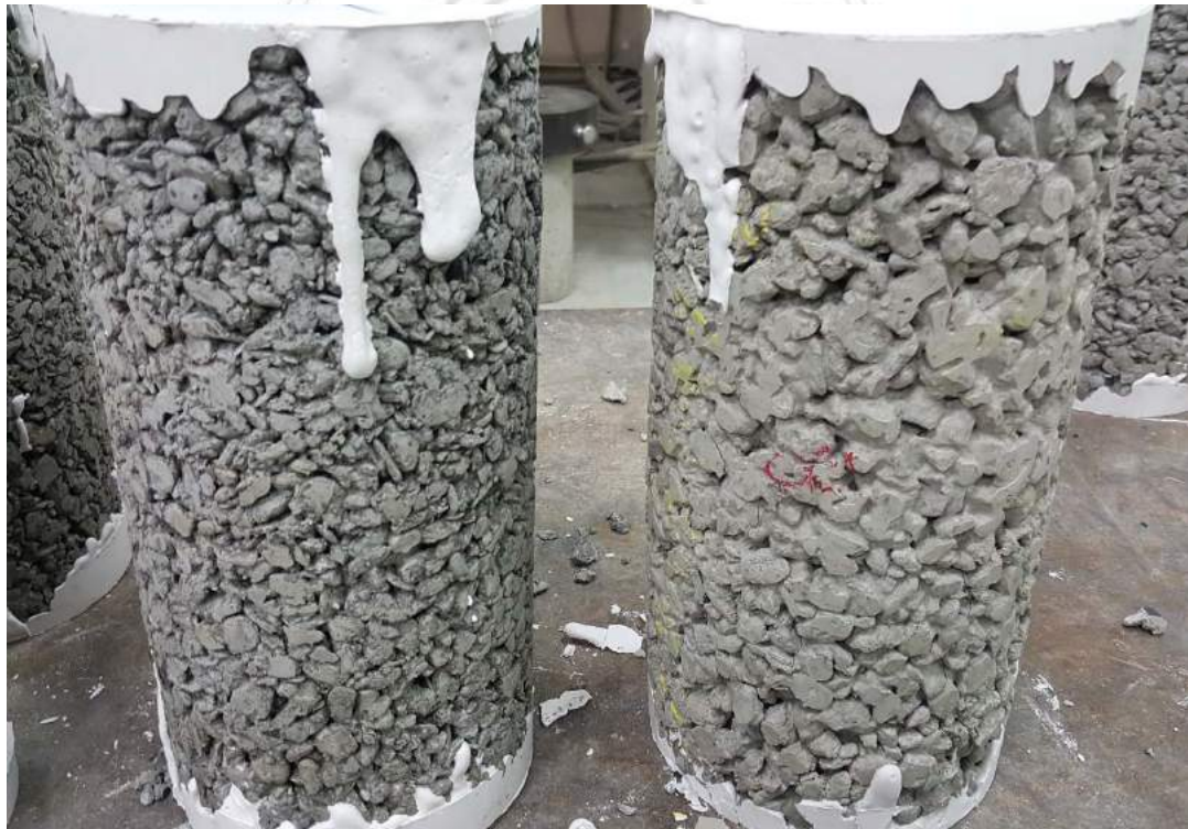
圖 3.8 實驗中混凝土抗壓性試驗配比(4-1、4-2 組)
