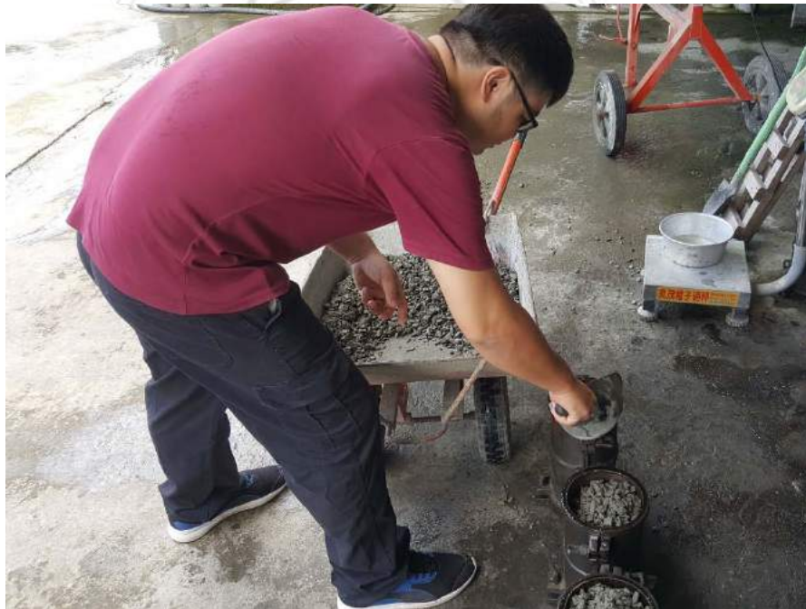
(g) 試體材料夯實分三次動作進行
