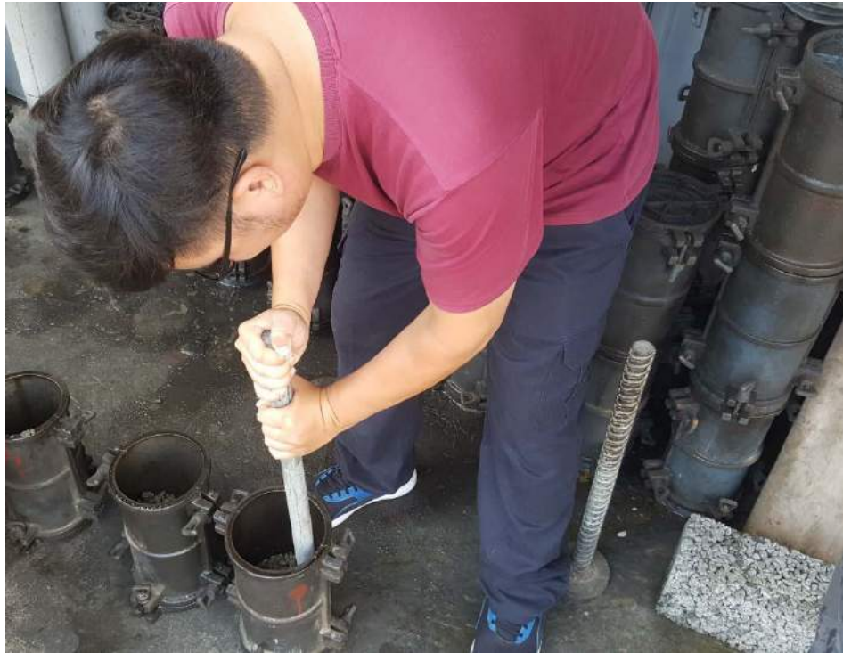
(f) 將試體材料倒入模組進行夯實
