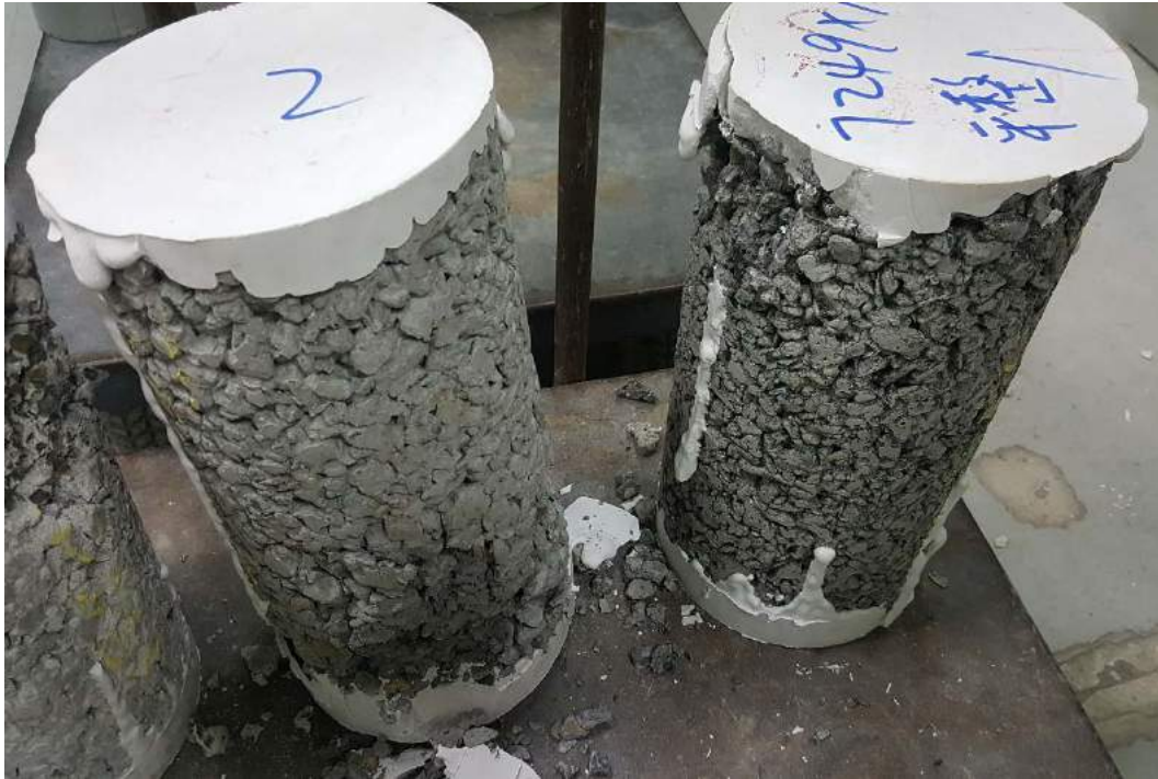
圖 3.5 實驗中混凝土抗壓性試驗配比(1-1、1-2 組)
