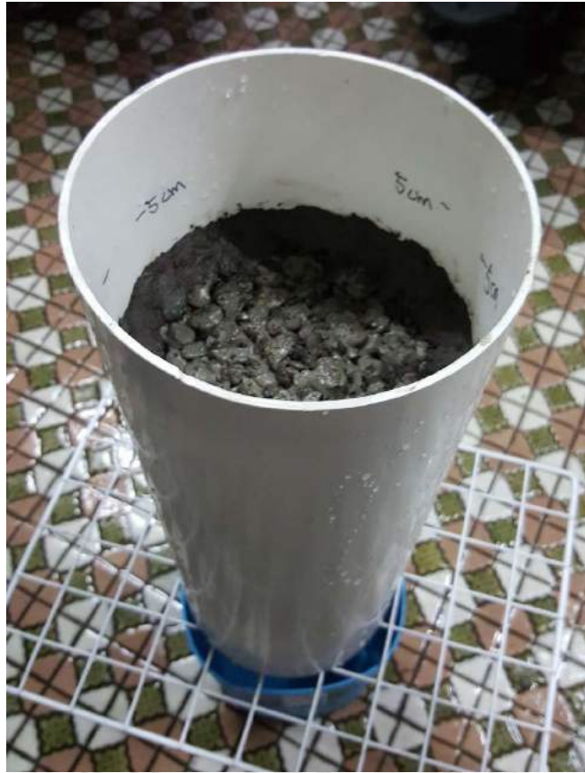
圖 3.11 周圍接縫填補並於內管註記 5 公分
