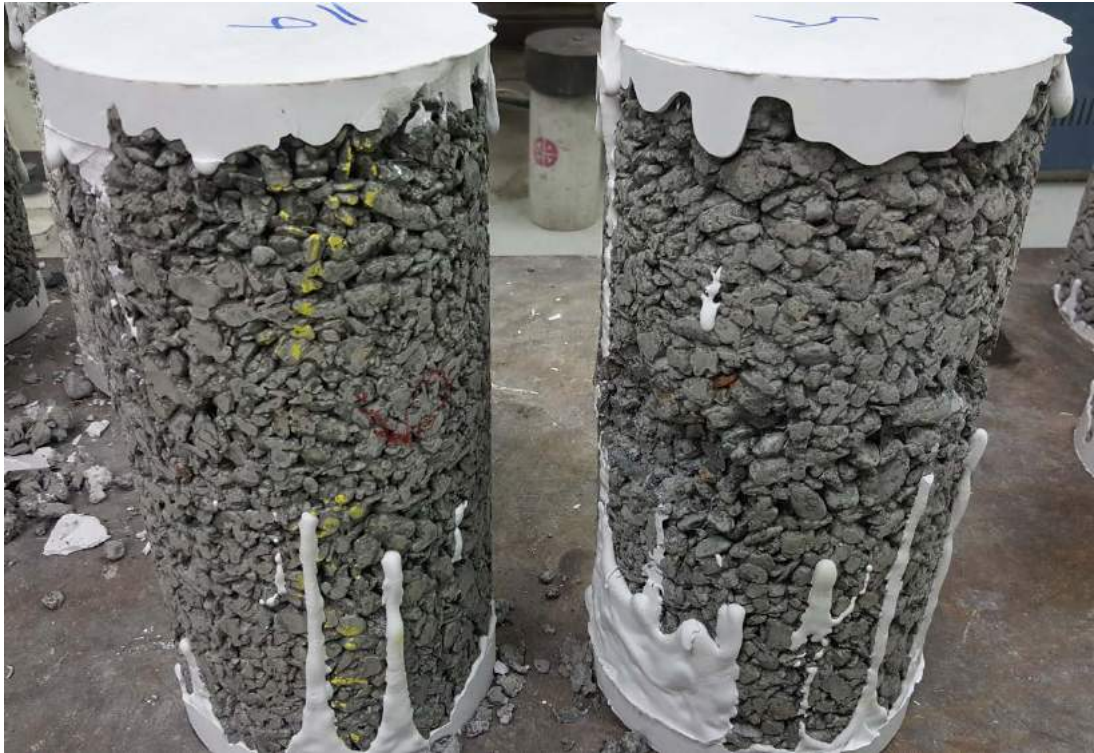
圖 3.7 實驗中混凝土抗壓性試驗配比(3-1、3-2 組)
