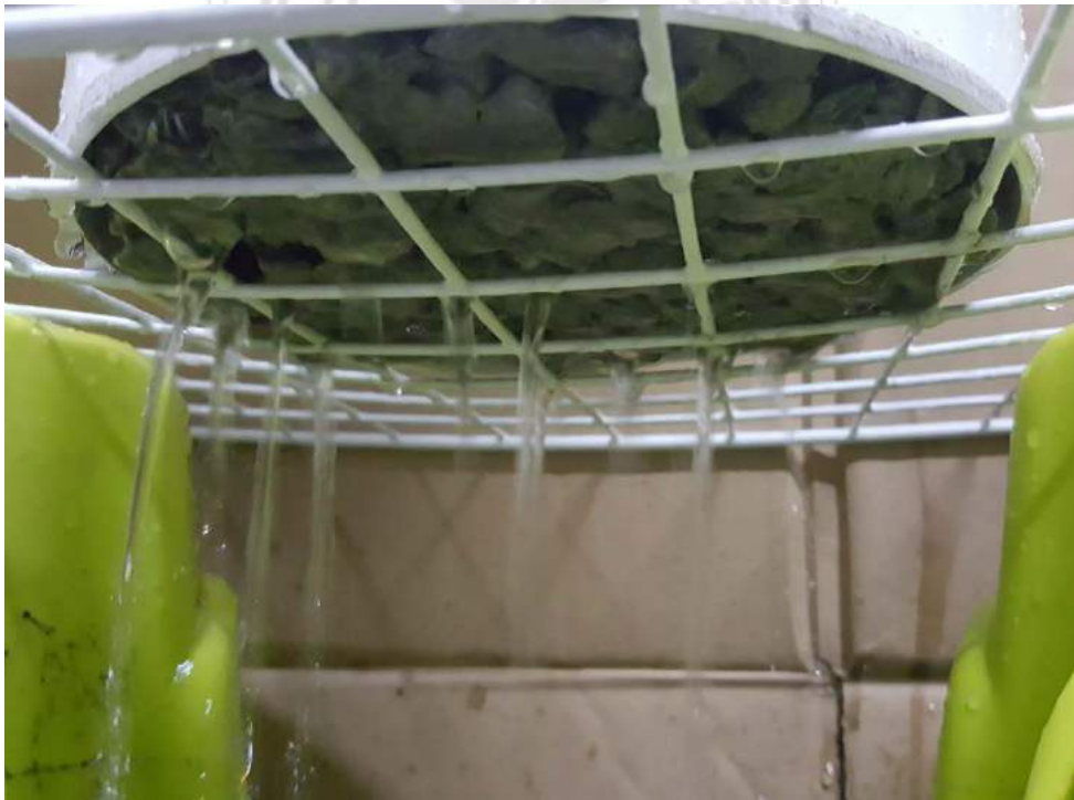
圖 3.12 測試試體均有良好透水
