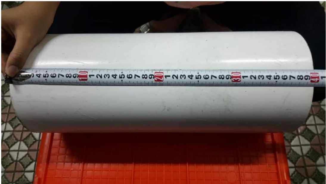
圖 3.10 直徑 6 英吋高 40 公分 PVC 管
