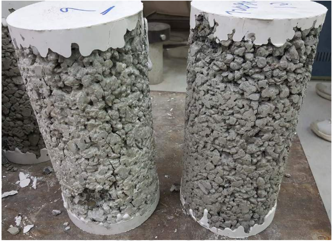
圖 3.9 實驗中混凝土抗壓性試驗配比(5-1、5-2 組)
