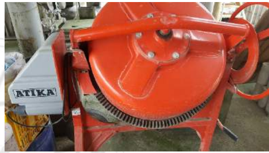
4. 混凝土攪拌機
