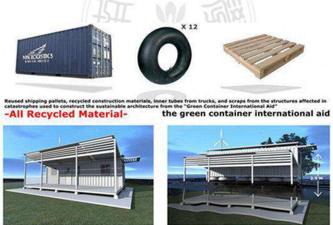
圖 3-17 貨櫃屋材料與最高漂浮高度 2.5 公尺示意圖
