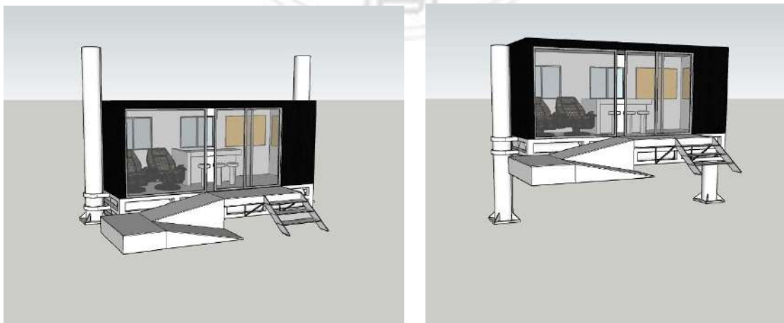
圖 4-14 乾式防水屋升降示意 3D 圖
