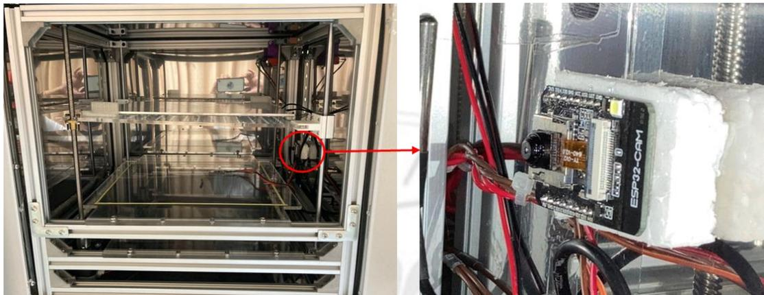
圖 47、ESP32-CAM 安裝位置
