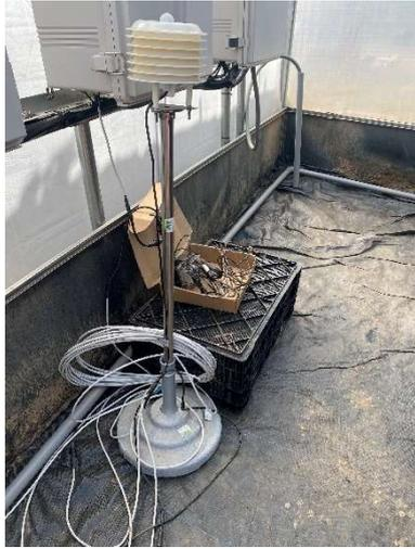
室內氣象站：內建溫度、濕度、光照、二氧化碳、土壤溫濕度 PH、EC 偵測器。
