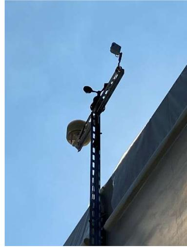
室外氣象站：內建雨滴感知器、風速、溫度、濕度、光照、二氧化碳偵測器。
