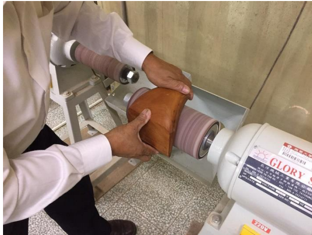
圖 2-4-7 氣鼓式砂磨機(研究者拍攝)
