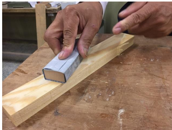
圖 2-3-2 砂紙包裹著一塊軟木做的打磨塊(研究者拍攝)
