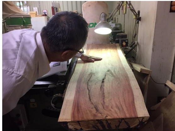
圖 2-3-6 利用側光源檢查板面是否平整(研究者拍攝)
