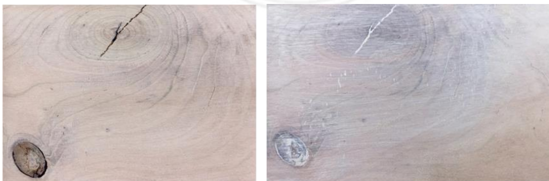
圖 2-1-3 補土修補裂縫及節孔前後情形(研究者拍攝)
