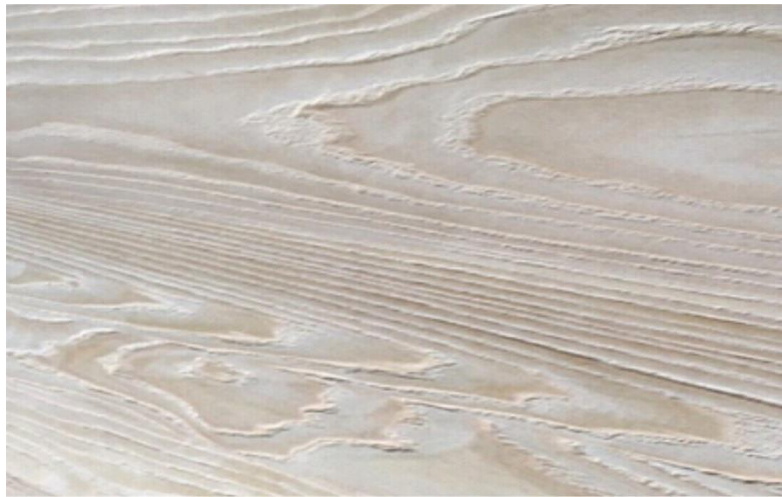
圖 2-1-6 以「鋼刷」技法處理的木材表面情形(研究者拍攝)
