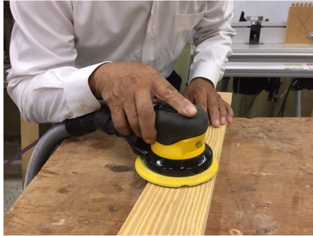
圖 2-4-2 氣動圓盤式砂磨機(研究者拍攝)
