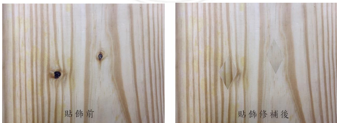
圖 2-1-5 以「貼飾」技法修補木節的情形(研究者拍攝)
