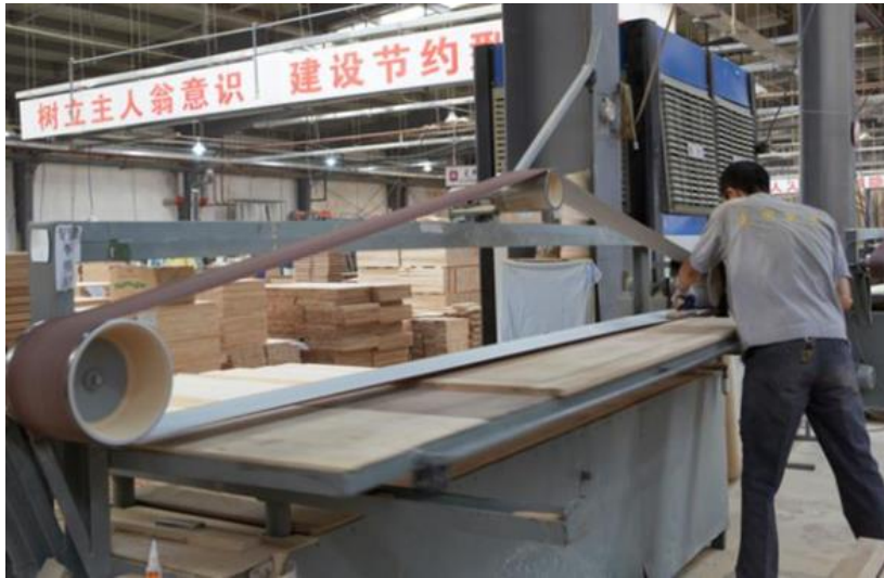
圖 2-4-5 手壓平台砂光機(研究者拍攝)
