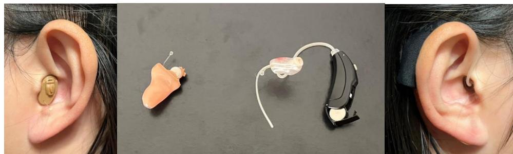
圖 8：左側耳內型助聽器與右側黑色耳掛型助聽器
