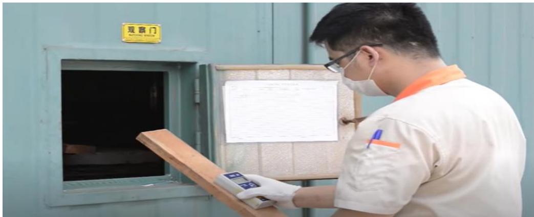
圖 2-6-1 以含水率測定儀檢測材料的溼度
