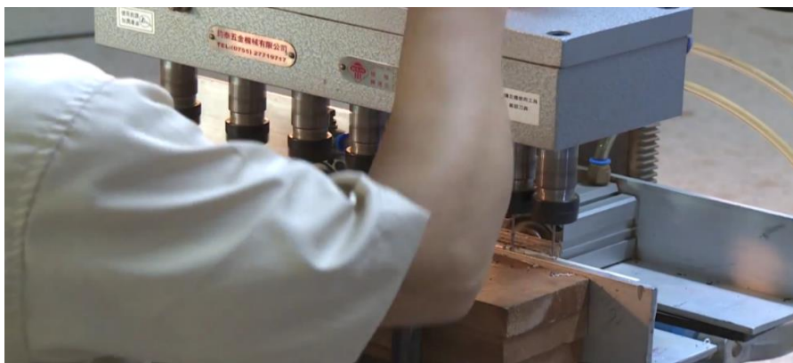
圖2-6-18 吉他琴頸品記定位一次性鑽孔
