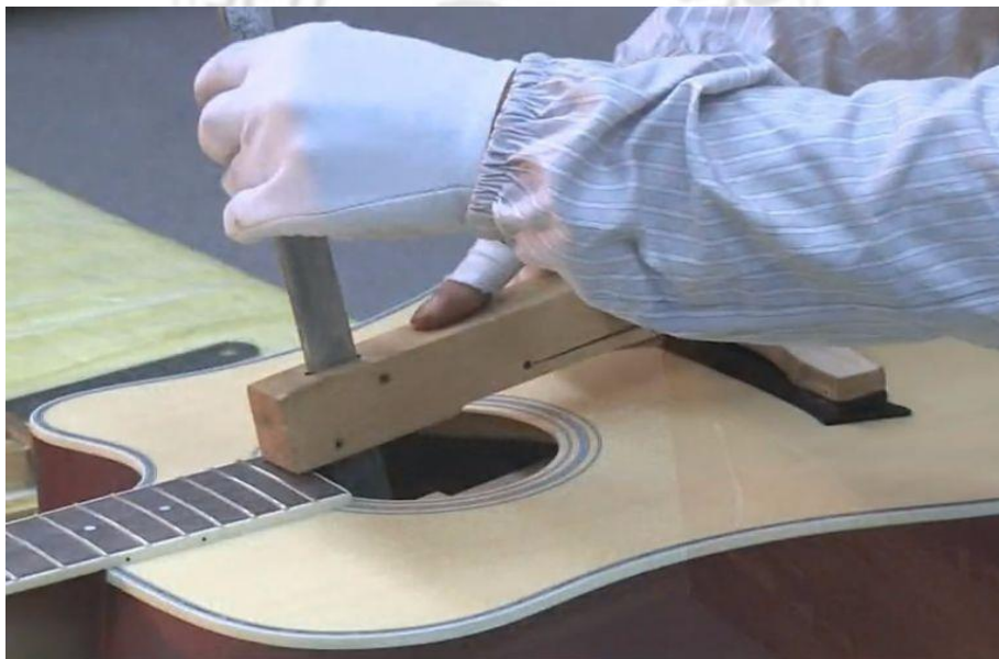
圖2-6-51 測量音孔至琴碼之間距離
