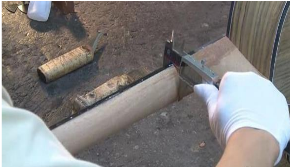
圖2-6-38 用游標卡尺檢測琴頸厚度
