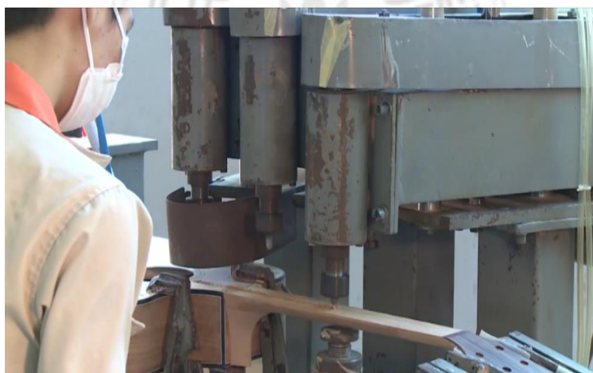
圖 2-6-31 桶身與琴頸鳩尾結構以氣壓機加壓接合
