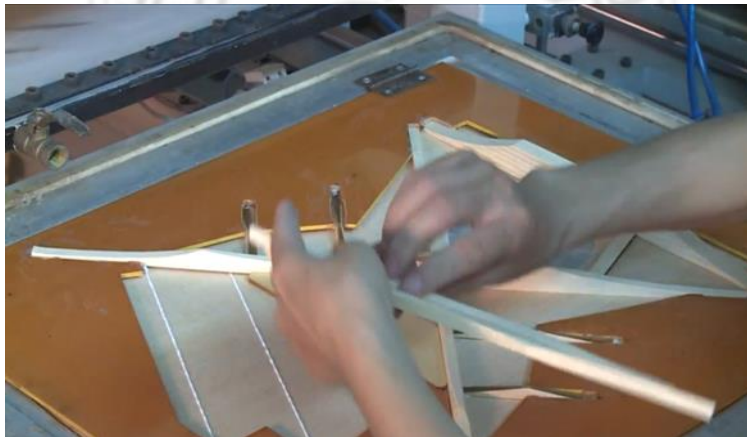
圖2-6-20 吉他音箱面板力木膠合
