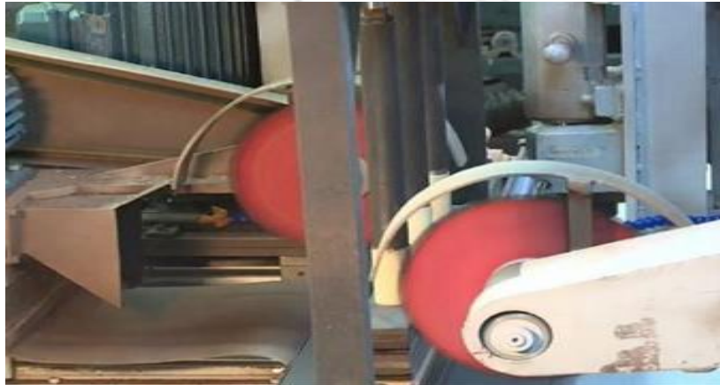
圖2-6-10 氣壓機將木板整理壓平
