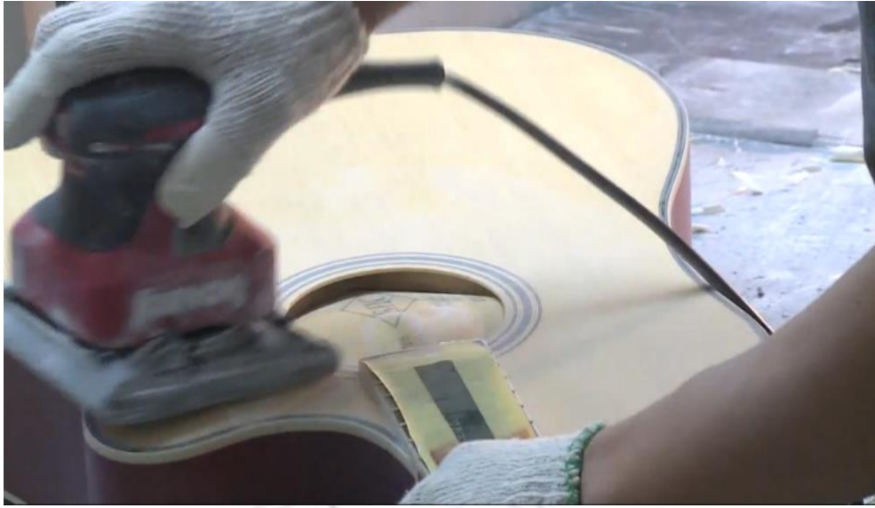
圖2-6-46 用手動磨砂機修整打磨吉他面板
