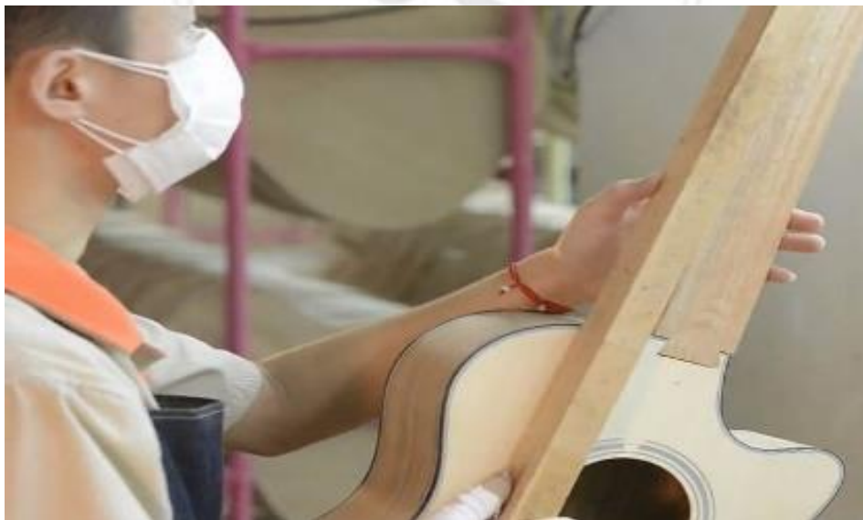
圖2-6-33 以直木條檢測吉他琴頸至音孔的角度
