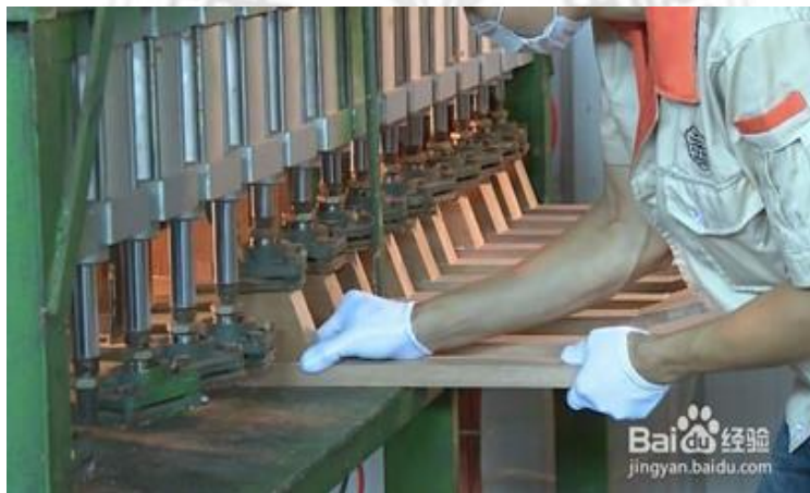
圖2-6-6 氣壓夾具固定膠合琴肩
