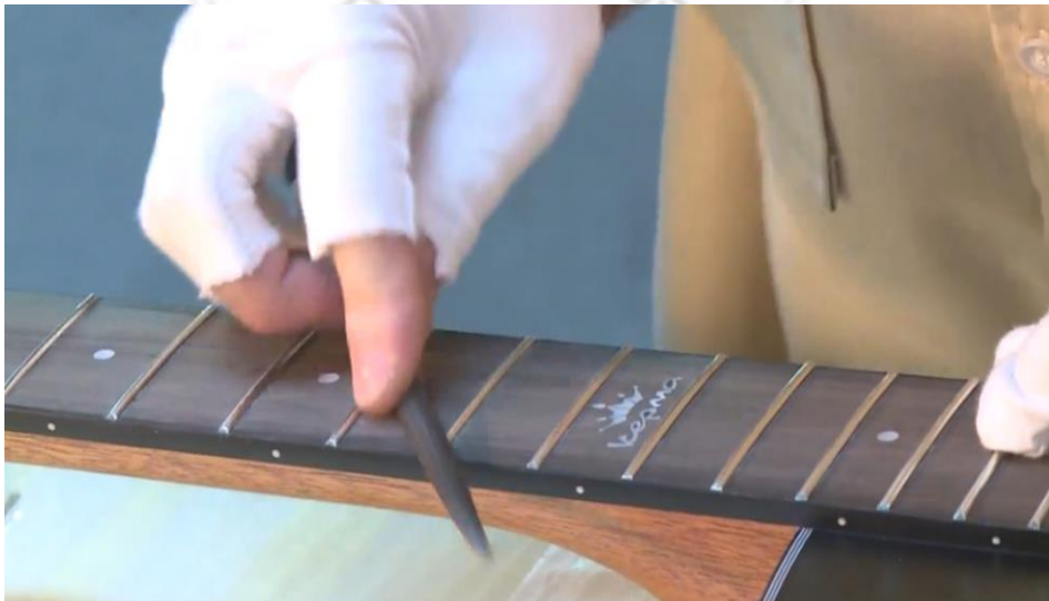
圖2-6-45 品絲兩端用銼刀修整並導角 75 度
