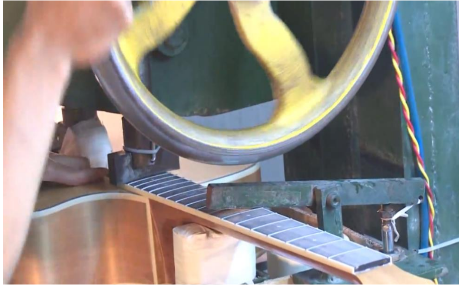
圖2-6-42 品絲壓平修整
