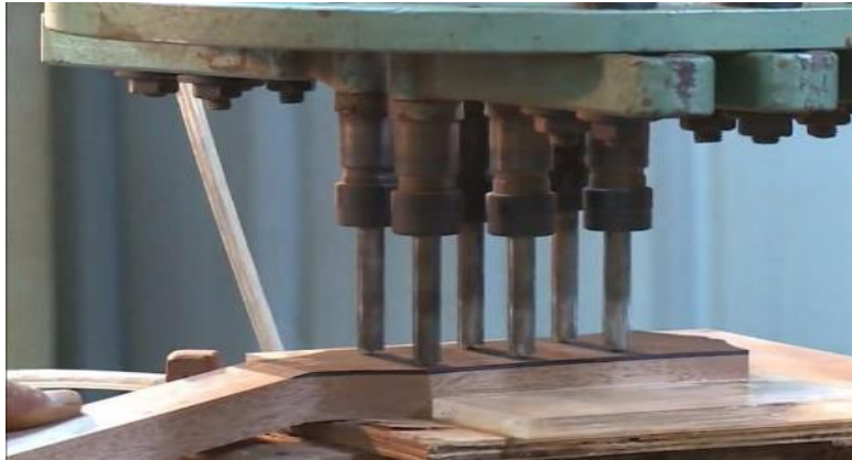
圖2-6-9 琴頭以氣壓式排鑽一次性鑽六個弦鈕孔洞
