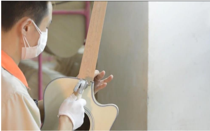
圖 2-6-32 琴頸與桶身榫接接合不平整以鐵錘敲平修整
