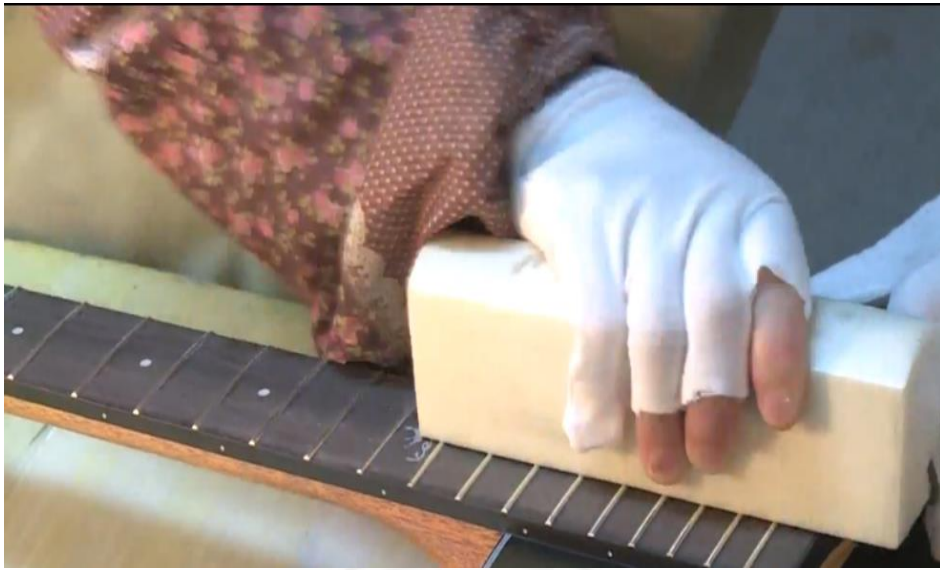
圖2-6-44 測量品絲水平
