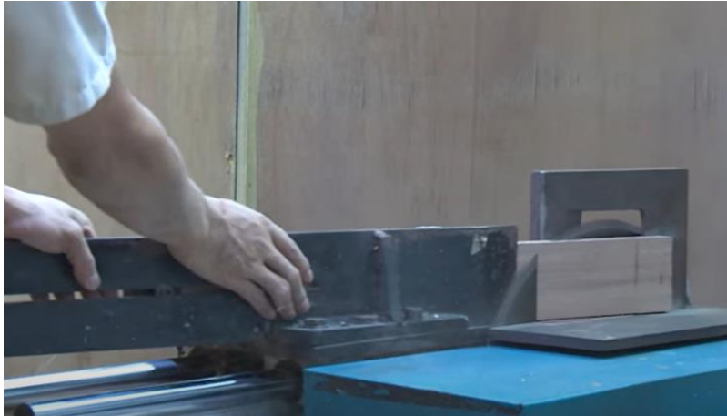
圖2-6-3 利用圓鋸機將柄料以 14^\circ 斜鋸開
