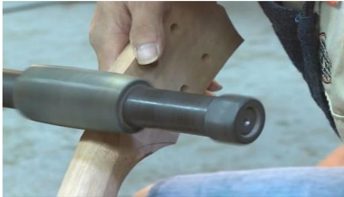
圖2-6-7 以滾動式砂磨機修飾琴頭與琴頸
