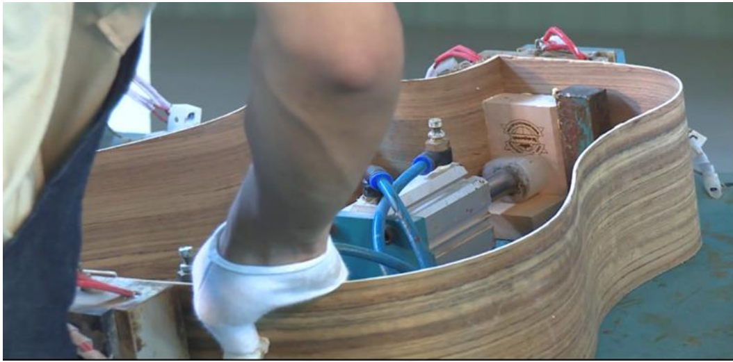
圖2-6-24 側板膠合使用木枕固定防止接合處鬆開
