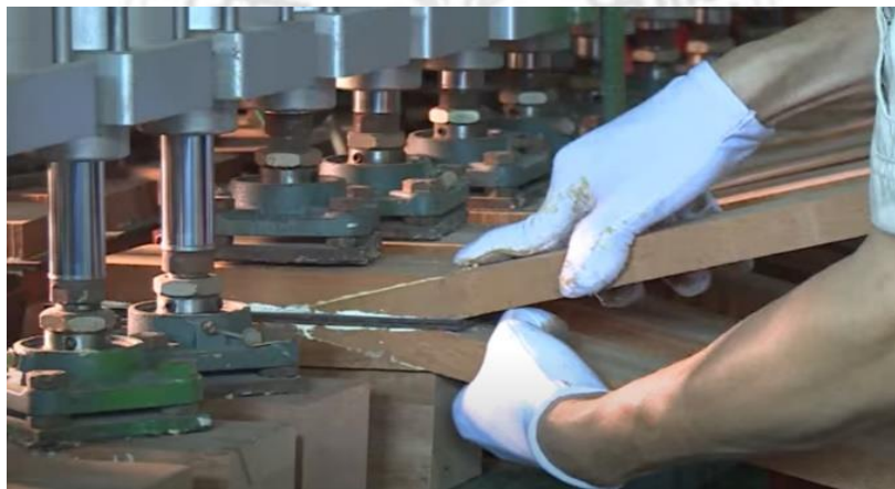
圖2-6-4 利用氣壓機夾具同時膠合二組琴頭及琴頸
