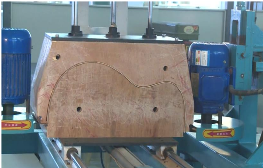
圖2-6-22 加壓進行桶身積層的膠和
