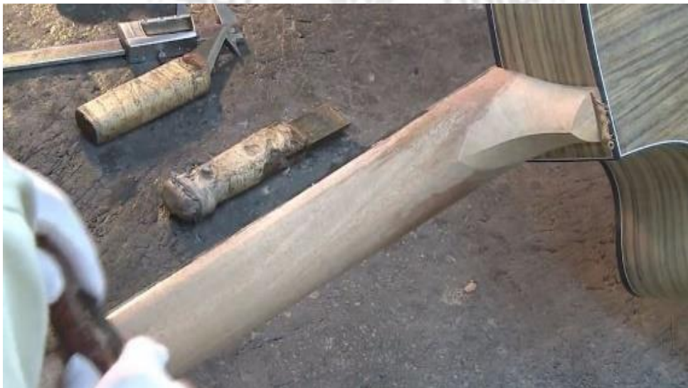
圖2-6-39 以彎鉋修飾琴頸的圓弧表面
