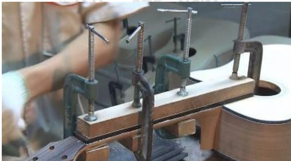
圖2-6-37 琴頸與指板利用夾具加壓膠合
