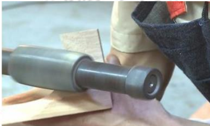
圖2-6-8 滾動式砂磨機琴肩尾端打磨
