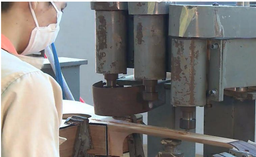
圖2-6-35 吉他琴頸中間開琴骨溝槽
