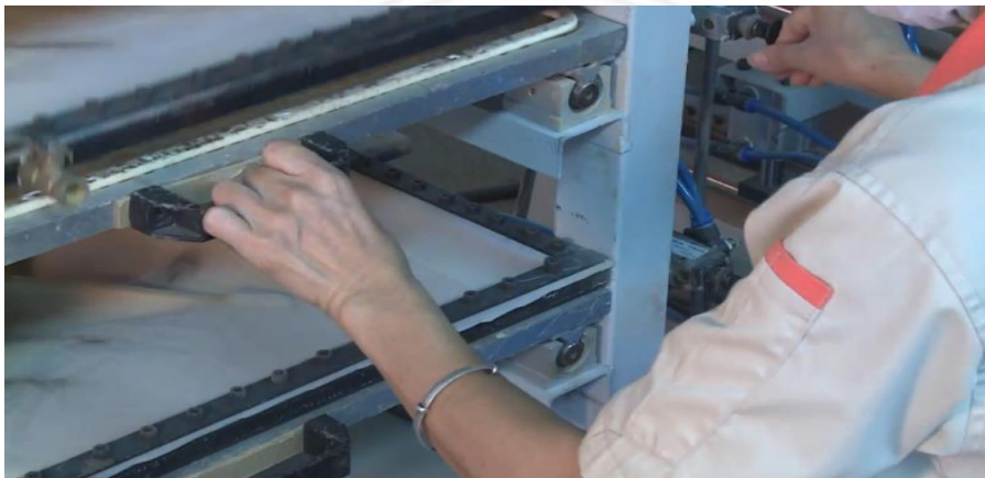
圖 2-6-17 音箱面板的力木以壓力板加壓固定膠合
