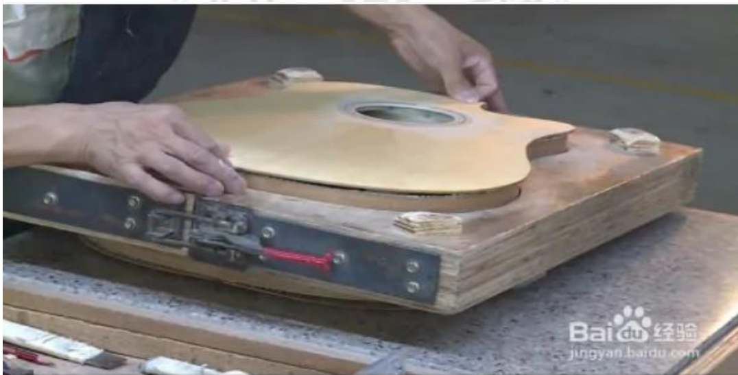
圖 2-6-25 吉他面板、背板、側板定型模固定膠合
