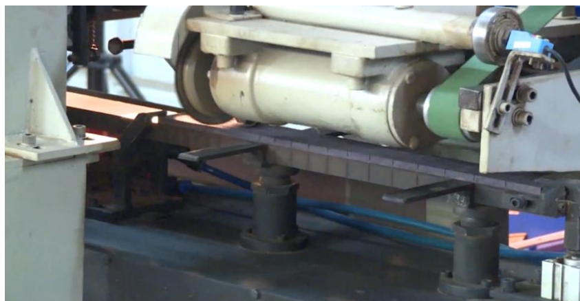
圖2-6-11 吉他琴頸面板溝槽定位鋸切以放置品絲
