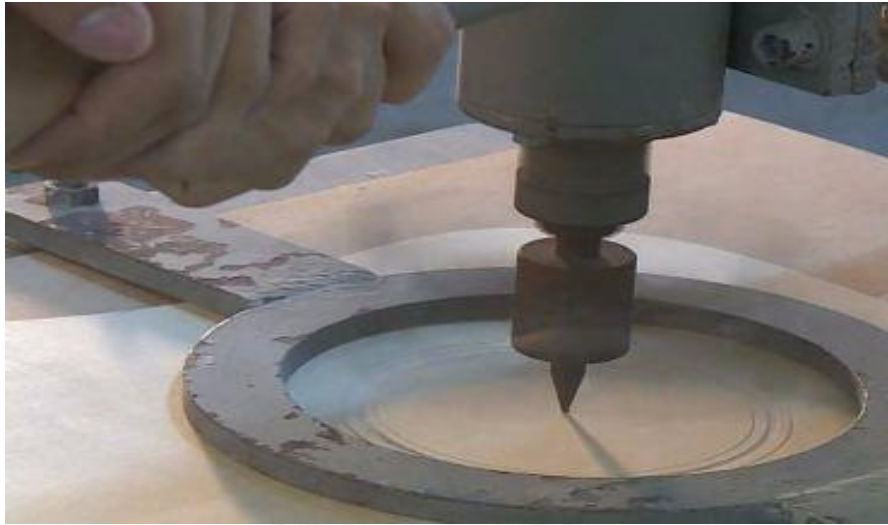
圖2-6-19 使用鑽床鑽出音孔以及需要鑲嵌的音孔三圈花邊淺溝槽
