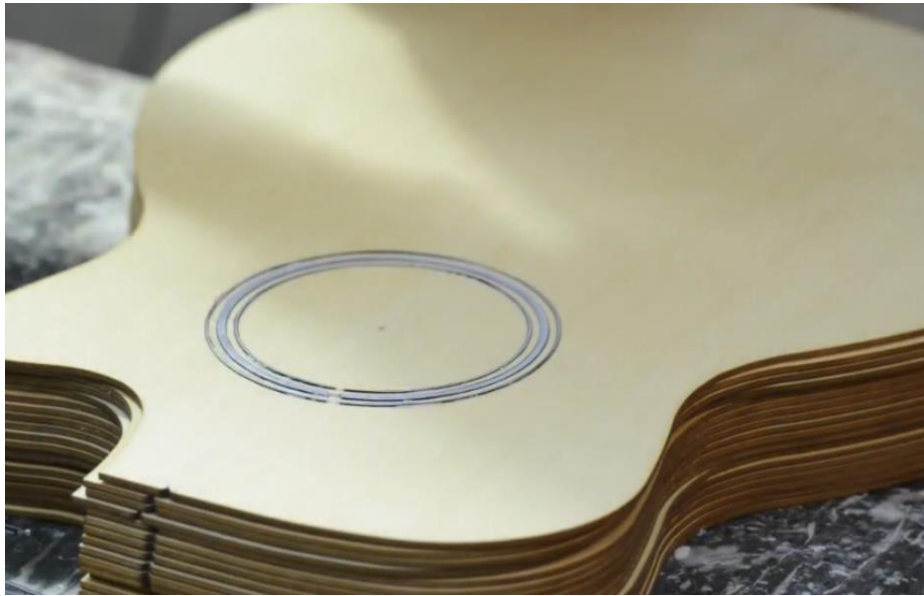
圖 2-6-14 吉他面板音孔的切割加工
