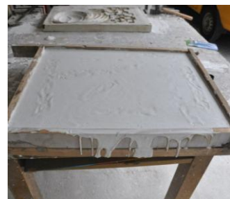
圖 3-5-23 倒入石膏溶液 圖 3-5-24 鋪上玻璃纖維布 圖 3-5-25 等待凝固
