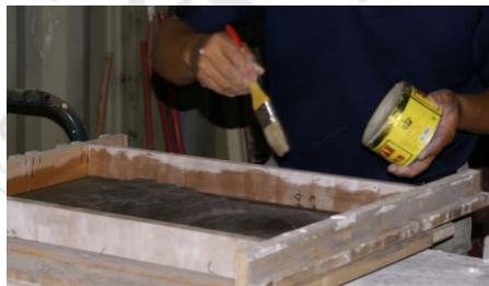
圖 3-5-20 四周圍上木板 圖 3-5-21 刷上地板臘當作隔離劑 圖 3-5-22 調石膏液
