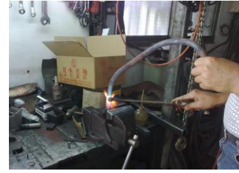
圖 3-5-40 鋼條加溫彎曲
