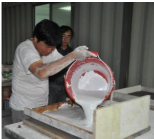
圖 3-5-23 倒入石膏溶液 圖 3-5-24 鋪上玻璃纖維布 圖 3-5-25 等待凝固
