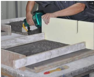
圖 3-5-20 四周圍上木板 圖 3-5-21 刷上地板臘當作隔離劑 圖 3-5-22 調石膏液
