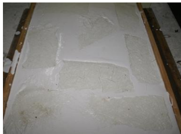
圖 3-5-23 倒入石膏溶液 圖 3-5-24 鋪上玻璃纖維布 圖 3-5-25 等待凝固
