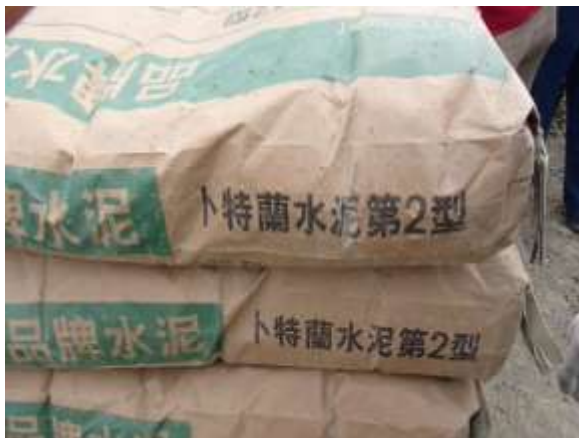
圖 3.2.2-13 在海邊施作時所使用的水泥（本研究拍攝 2011.10）
