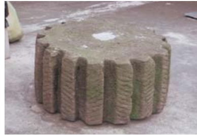
照片 2.2 取山區原石材製石齒輪 資料來源：本研究拍攝，2011.02.15
