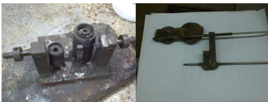
圖 2-6：銀焊用的模具（左）與錫焊用模具（右）。
