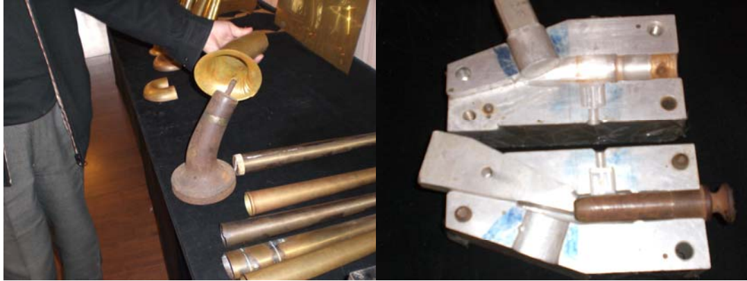
圖 2-2：管身製作用的模具，左為喇叭口的部份，右為吹嘴的部份。
