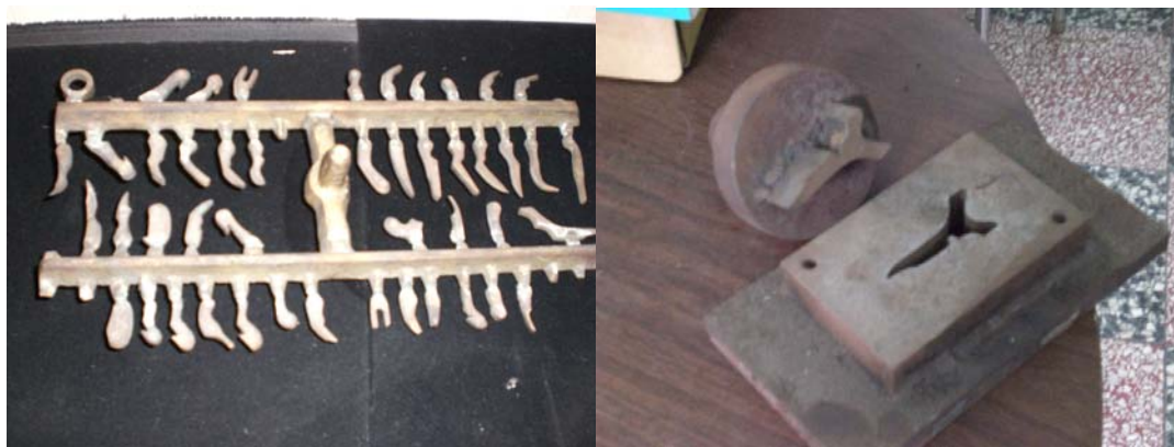
圖 2-5：以鑄模方式製作的零件組（左）與零件沖壓的模具（右）。
