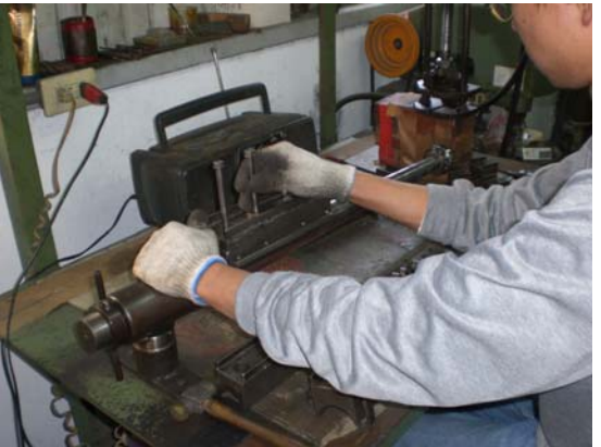
圖 3-1-4：套入管身，並在其上外覆音孔模具。
