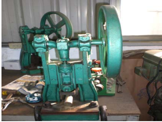
圖 3-1-1：以此一沖壓機器在管身上固定位置打洞。
