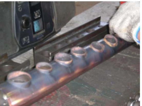
圖 3-1-6：取下外覆的音孔模具，即可見成型的音孔。
