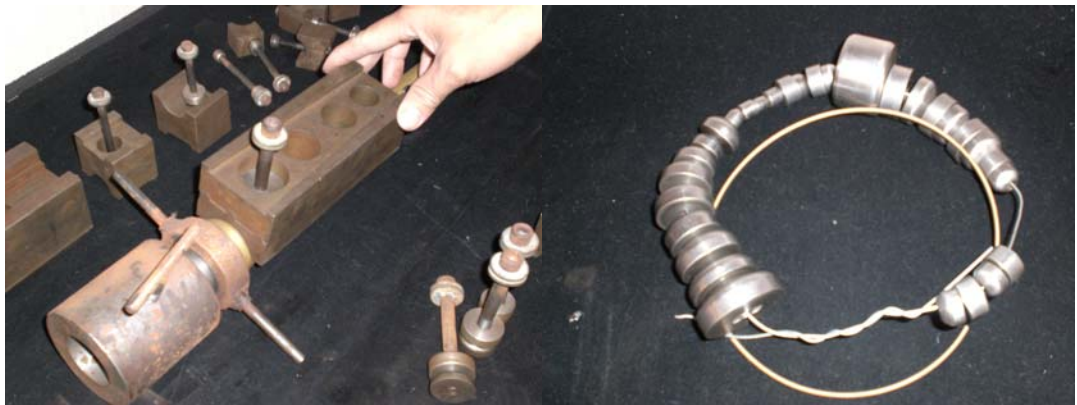
圖 2-3：音孔模具，左為外覆於管身的模具，右為音孔模具的內芯。
