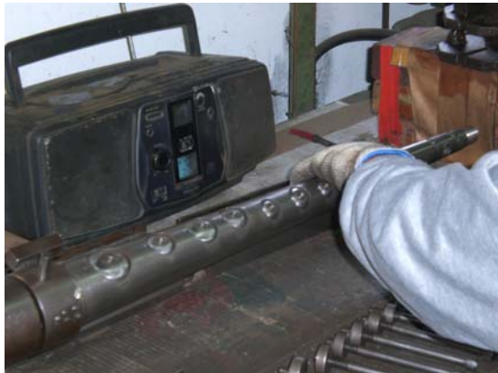
圖 3-1-3：在管身模具上置入音孔模具的內芯。
