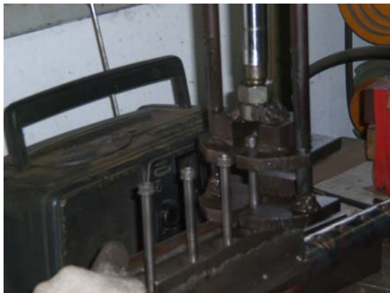
圖 3-1-5：將油壓機械接上外覆的音孔模具，並進行抽拉。
