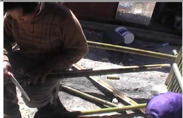
【圖 4-52】長老用這個模具來鋸出一根根等長的竹子。〈筆者，2006.12，玉峰〉
