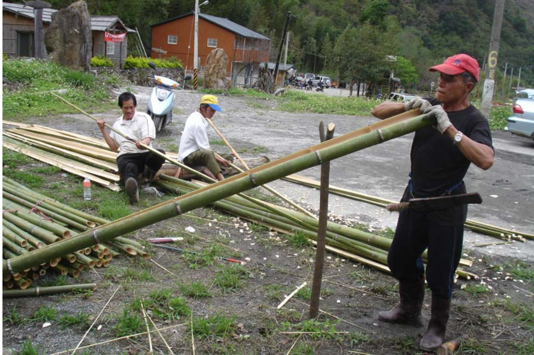
【圖 4-15】用雙手直接掰開實例〈筆者，2006.11，玉峰〉
