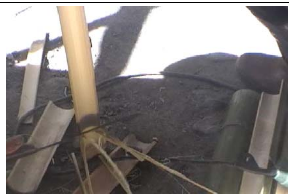
【圖 4-50】然後用刀子從竹尾的地方，削到剛剛距離竹節兩公分記號的時候，把兩邊削薄，把中間竹節削掉。〈筆者，2006.12，玉峰〉
