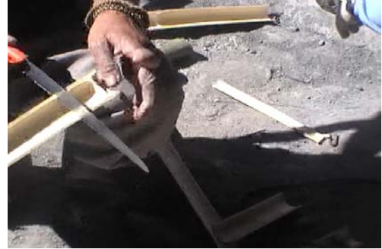
【圖 4-48】為了製作標準竹，長老先在距離竹節兩公分之處，用鋸子作一個記號 〈筆者，2006.12，玉峰〉
