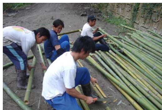
【圖 4-13】依照標準竹長度而分竹實 例〈筆者，2006.11，玉峰〉
