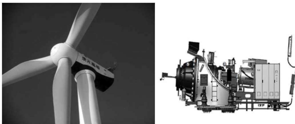
圖 3-7 國產 2MW 風力離型機(左)、國產 2MW 風力機機艙組合圖(右)
